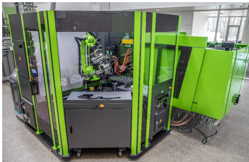
Image 2 : Robot easix en action : les robots à six axes easix d'ENGEL se distinguent par leur haute flexibilité et leur design compact - idéaux pour des tâches d'automatisation complexes dans des espaces confinés.
