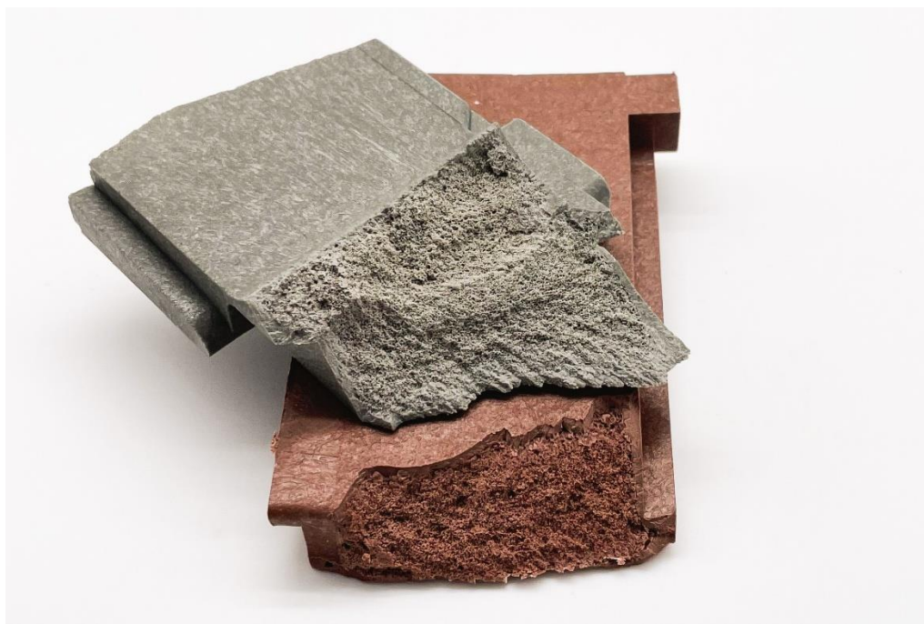
Image 2 : Léger, stable, durable : section transversale du composant parfaitement moussée fabriqué à partir de 100% de recyclat post-consommation, offrant 30% de poids en moins et 10% de résistance aux chocs en plus.
