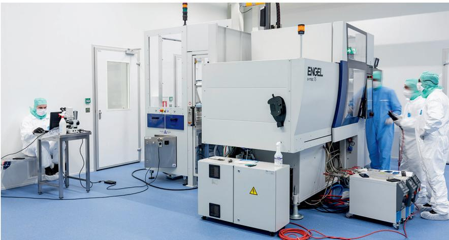
▲ Reinraumproduktion bei Helvoet in den Niederlanden. Das Unternehmen hat sich auf Präzisions-spritzgießprodukte spezialisiert und setzt dafür vollelektrische Spritzgießmaschinen ein.
