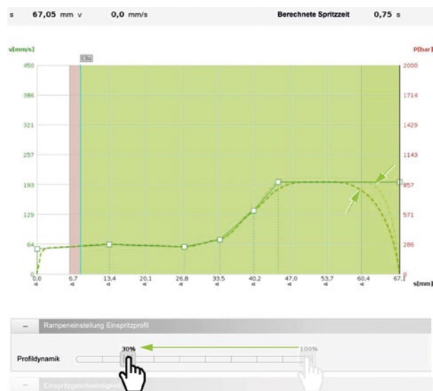
Рис. 1: Сенсорный экран пульта управления литейной машины: предварительно рассчитанный профиль скорости впрыска (штриховая кривая) показывает ожидаемое поведение скорости, основанное на предустановленных заданных значениях. Изменение динамики профиля (зазор между зелеными стрелками) позволяет регулировать движение более плавно или динамично. Эффект становится более наглядным во время движения ползунка, перемещаемого оператором непосредственно на экране пульта управления (здесь и на фото 2 и 3: s – ход шнека справа налево, мм; v – скорость впрыска, мм/с; p – давление впрыска; Berechnete Spritzzeit – рассчитанное время впрыска, с)
