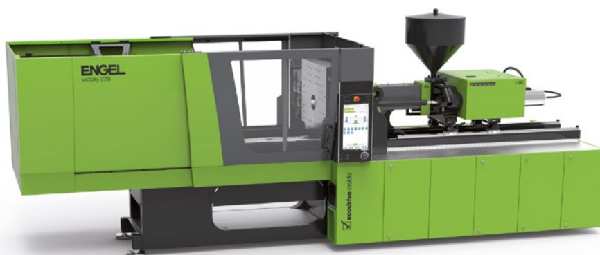
Бесколонные ТПА ENGEL – это идеальная параллельность плит, равномерное распределение усилия смыкания и максимум пространства в зоне формы
