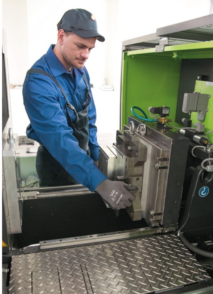
С использованием бесколонной конструкции время замены литейной формы на ТПА сведено к минимуму и может составлять до рекордных 5 минут
