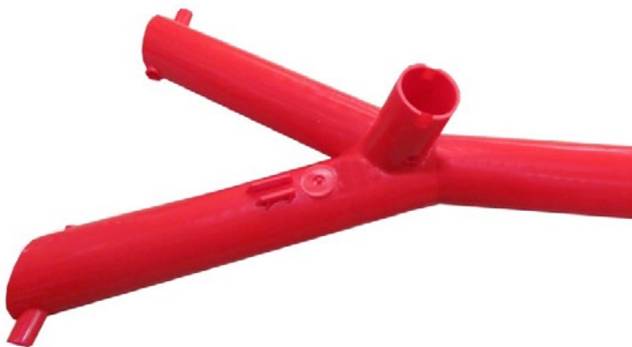
Рама детского велосипеда, произведенная компанией «Полесье» на бесколонном ТПА ENGEL victory 400
