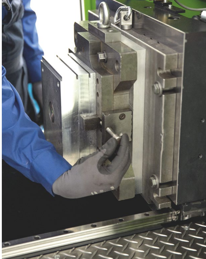
С использованием бесколонной конструкции время замены литейной формы на ТПА сведено к минимуму и может составлять до рекордных 5 минут
