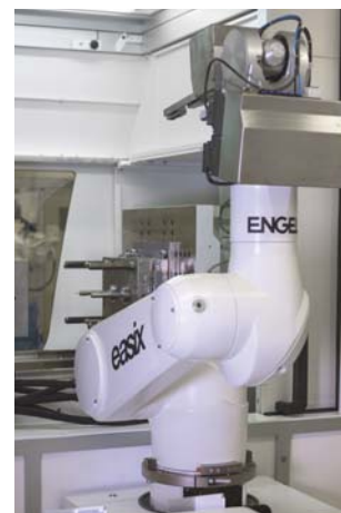
Оснащенная роботом easix машина victory 80 используется для изготовления образцов и мелкосерийного производства
