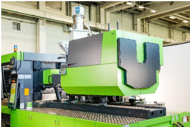
Fig. 1: Die neuen, vollelektrischen High-Performance Spritzeinheiten von ENGEL erweitern die Einsatzmöglichkeiten von elektrischen Spritzgießmaschinen für den Dünnwand-Spritzguss deutlich.
