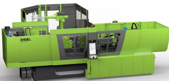
*Un manubrio per bicicletta ad alta resistenza viene stampato sulla pressa a iniezione senza colonne ENGEL victory 180 – produzione leggera e automatizzata con rinforzo in fibra continua grazie a fluidmelt e organomelt.*
