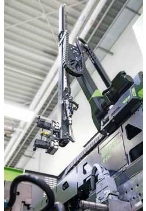
Der Z-Träger des e-pic ist gleichzeitig der Ständer. Mit der Schwenkbewegung passt sich der Roboter an die Höhe der Spritzgießmaschine an. Zusätzliche Montageelemente sind nicht notwendig
