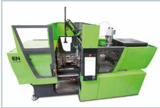
deutlich weniger Platz als ein Linearroboter. Er lässt sich in die Schutzumwehrung der Spritzgießmaschine integrieren und hält damit die gesamte Fertigungszelle kompakt. Im Gegensatz zur x-Achse eines Linearroboters kann der Schwenkarm Hindernisse, wie Aufbauten am Werkzeug, einfach und schnell umfahren. Dies lässt sich als Standardoption bei Maschinen bis 2200 kN Schließkraft auswählen
