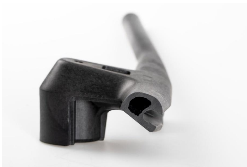
Image 3 : Le procédé fluidmelt d'ENGEL permet de produire des composants à corps creux avec une liberté de design exceptionnelle. La photo représente une coupe transversale du guidon du vélo. Image : ENGEL
