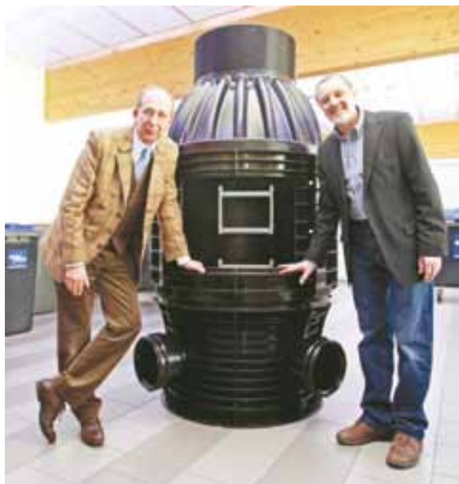
Фото 2. Коммерческий директор компании Europlast Хельмут Кубин (Helmuth Kubin) (слева) совместно с коммерческим директором компании Romold Фридрихом Эбнером (Friedrich Ebner) представляют изготовленный полностью из полипропилена по технологии литья под давлением смотровой колодец, имеющий впечатляющие характеристики: внутренний диаметр – 1000 мм, высота (с самым высоким промежуточным кольцом) – 2250 мм, общая масса – 110 кг (фото: Romold /Europlast)
