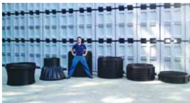
Фото 1. Компания Romold расширила свою программу поставок смотровых колодцев за счет создания полипропиленового варианта типоразмера DN 1000. Основными его частями являются (слева направо) предназначенное для подсоединения трубопроводов дно колодца, конус колодца с выходным отверстием и кольца колодца высотой 1000, 750, 500 и 250 мм (фото: Romold /Europlast)
