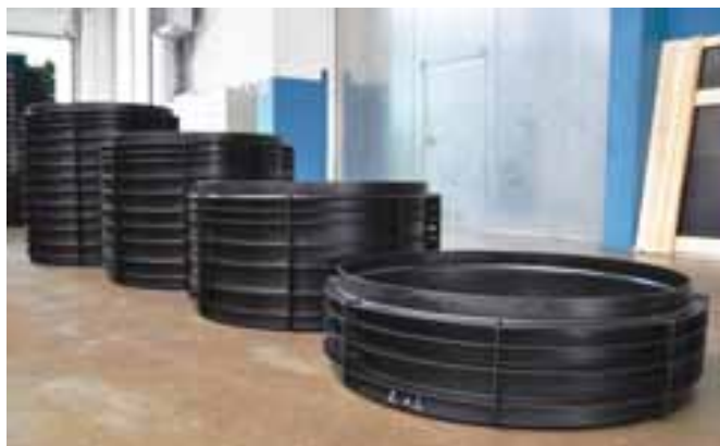
Фото 4. Переналадка на изготовление колец колодца другой высоты (250, 500, 750 или 1000 мм) осуществляется путем замены формообразующей вставки литевой формы (фото: Romold)
