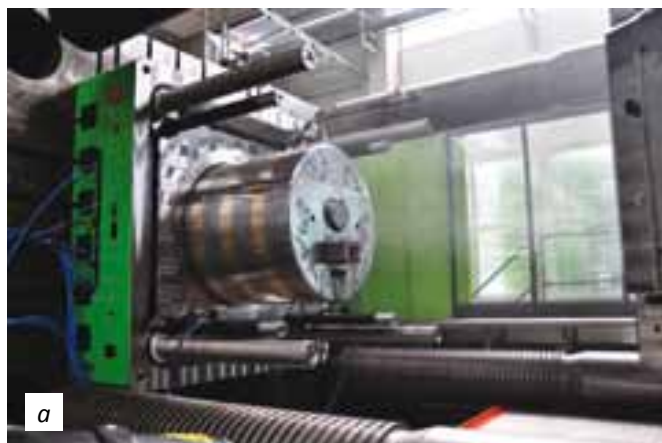
Фото 3. Универсальная конструкция литевой формы для изготовления колец колодца обеспечивает возможность формования всех четырех вариантов изделия, различающихся по высоте. Для этого в полуформах предусмотрены цилиндрический пуансон (а) и элементы матрицы (б) в сочетании с системой сменных формообразующих вставок (фото: Haidlmair)
