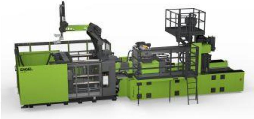
Las celdas de producción para el tratamiento de hojuelas de plástico se construyen de forma modular sobre la base de una máquina convencional de moldeo por inyección ENGEL duo. La celda de producción que se empleará en la feria K está equipada con un filtro de masa fundida de alto rendimiento de ETTLINGER y con una unidad de desgasificación.
