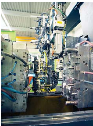
Робот ENGEL viper 40 вынимает четыре готовые детали
