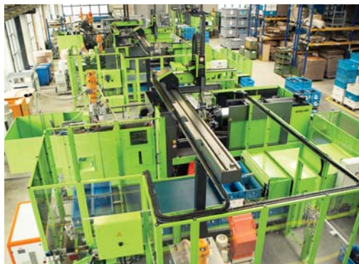
Ячейка на базе ТПА ENGEL victory с пакетом MuCell, блоком автоматизации с двумя линейными роботами ENGEL viper и системой смены ящиков
