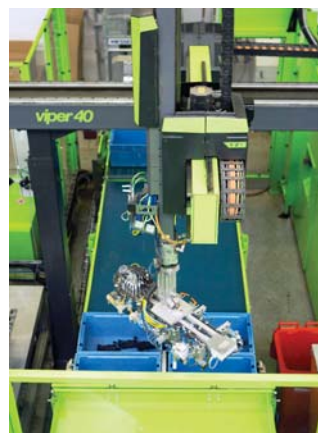
Один впрыск — две детали для левой и две для правой двери
