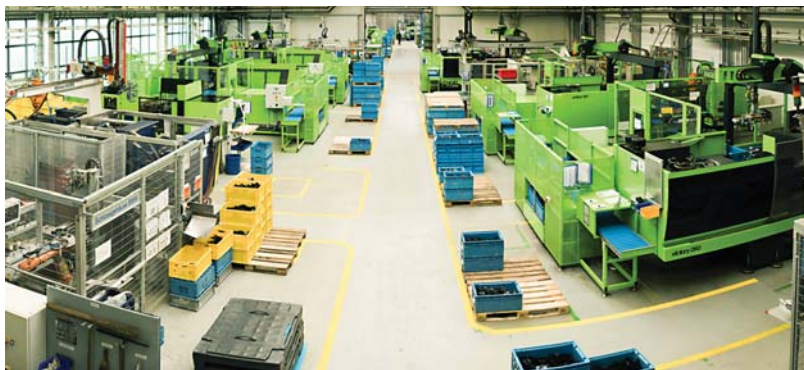
На заводе в Кирсфе установлены 52 литьевые машины с усилием смыкания от 25 до 500 т
