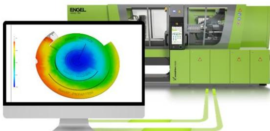
Mit sim link lassen sich Simulationsdaten direkt in die Spritzgießmaschine übertragen und umgekehrt Messdatensätze aus der Maschinensteuerung in das Simulationsprogramm importieren.
