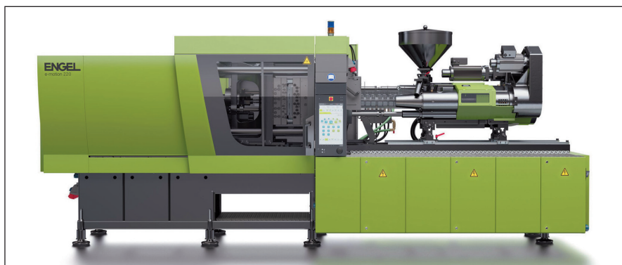
Фото 1. Внешний вид полностью электрической машины ENGEL e-motion 440/160 (фото: ENGEL)
