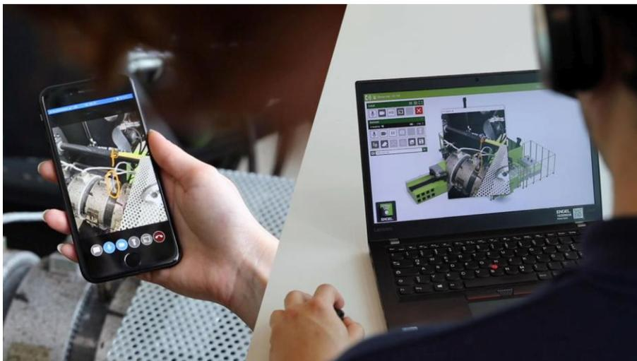
Online-Support mittels Videotelefonie: Ein Smartphone und eine Internetverbindung reichen aus. Wahlweise kann der Maschinenbediener oder Instandhalter vor Ort an der Maschine auch ein Tablet oder eine AR-Brille nutzen.
