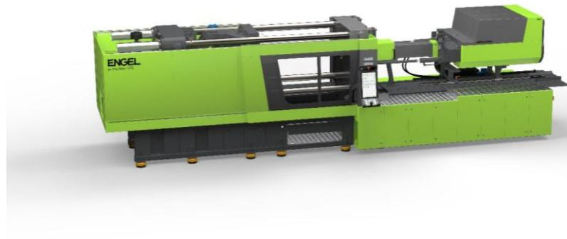
***En direct au K 2025 - l'application Packaging :*** le nouvel e-flomo ONE d'ENGEL en fonctionnement sur un e-motion 420, atteignant jusqu'à 50% de réduction de la consommation d'eau de refroidissement.
