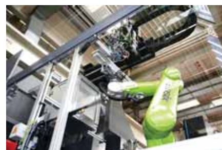
Фото 5. Многоосевой робот easix, интегрированный в систему управления литьевой машины victory 1350/300 tech
