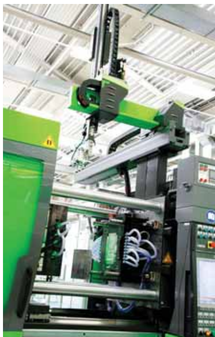
Фото 8. Автоматическое извлечение готовой панели электронной книги из формы, установленной на полностью электрической машине e-motion 940/200 T, осуществлялось линейным роботом ENGEL viper 20
