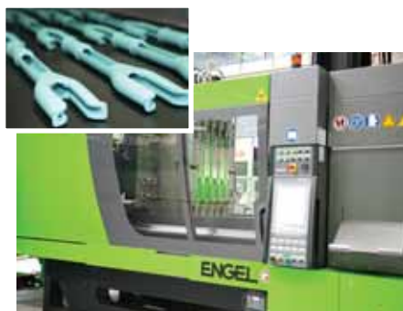
Фото 4. Литьевая машина модели victory 3550/500 tech для производства деталей швабры из ПП
