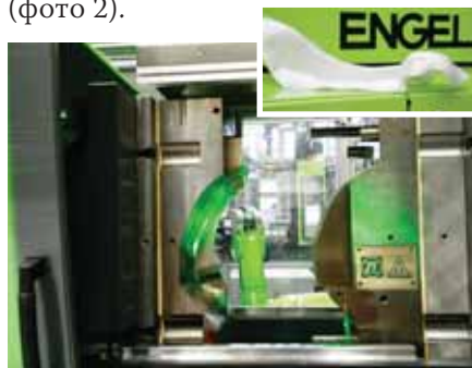
Фото 2. Одноместная форма и тканая стекловолокнистая заготовка для производства педали тормоза
