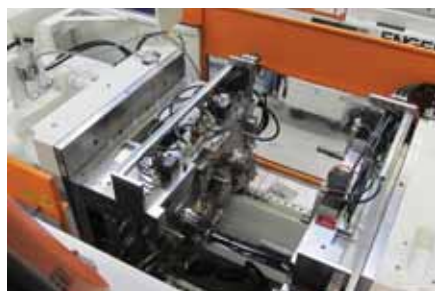
Фото 11. Отсутствие колонн на литьевых машинах victory tech позволило на заводе Volkswagen полностью реализовать полезную площадь крепежных плит и облегчить работам доступ в зону формы, за счет чего удалось сэкономить на производственных площадях и сократить время цикла
