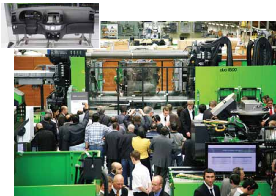
Фото 3. В «автомобильной» экспозиции внимание специалистов привлекала большая машина duo 11050H/4550M/1500 combi M, предназначенная для производства двухкомпонентной приборной панели автомобиля по технологии Dolphin
