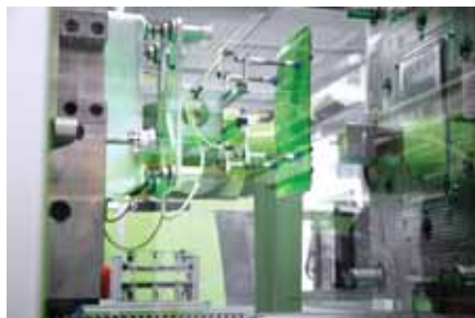
Фото 7. Извлечение готовой поликарбонатной крышки для ноутбука из формы с помощью многоосевого робота easix
