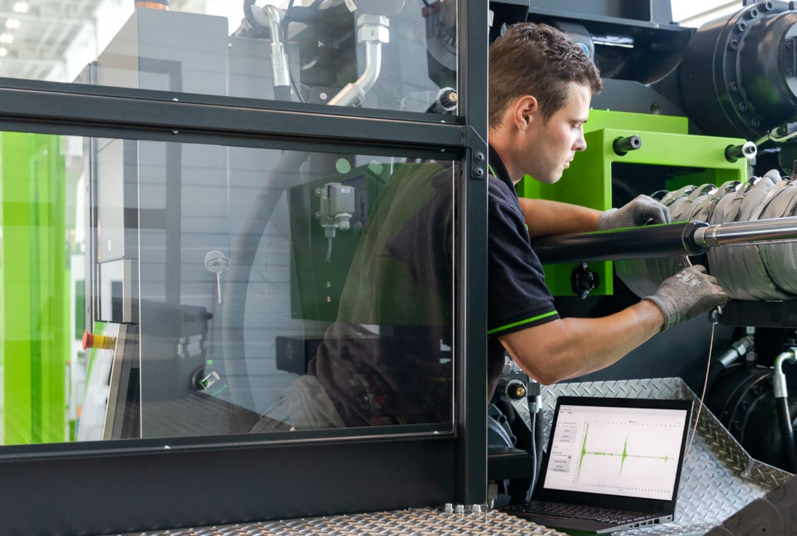
Ścieranie się zwojów ślimaka plastyfikującego wpływa na jakość. e-connect.monitor określa stan ślimaka bez jego demontażu.
