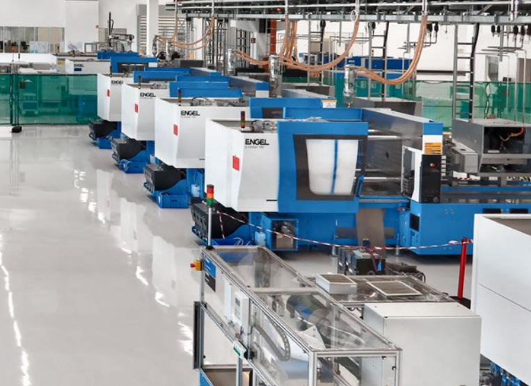
Ypsomed się rozwija. Ostatnio w Schwerinie powstał nowy zakład produkcyjny, wyposażony w całkowicie elektryczne wtryskarki ENGEL e-motion.
