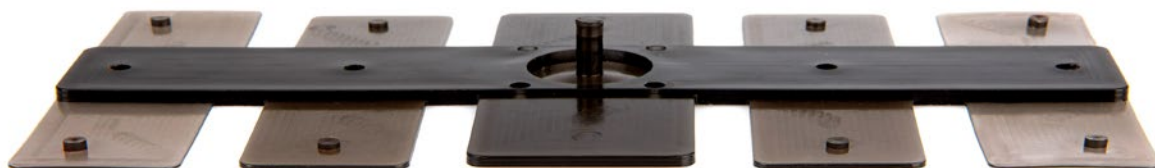
Rys. 3: Środkowy mostek płyty stopniowej ma grubość 3 mm. Ramiona boczne mają grubość 2, 1 i 0,5 mm, przy czym najcieńsze obszary znajdują się na końcu drogi płynięcia.
