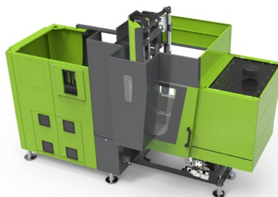
Kompaktowa integracja: szyb zrzutowy do wlewków.
