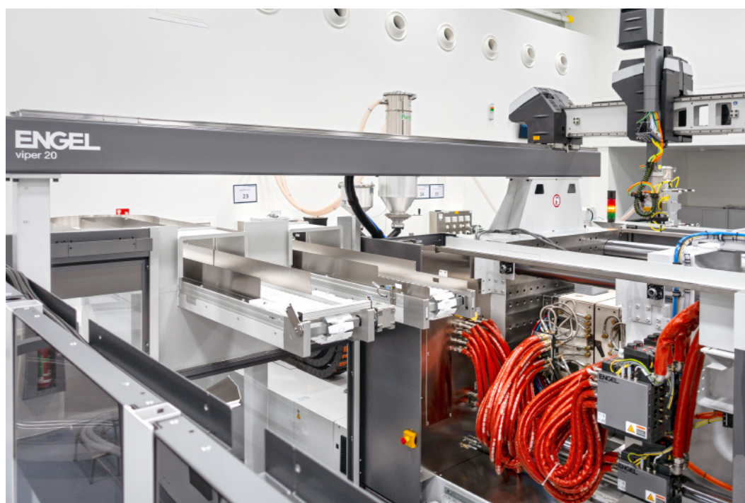
Roboty viper 20 wykonują dwa zadania: usuwanie wyprasek z formy wtryskowej oraz przenoszenie schłodzonych elementów z sekcji chłodzenia końcowego na przenośnik wyprowadzający.
