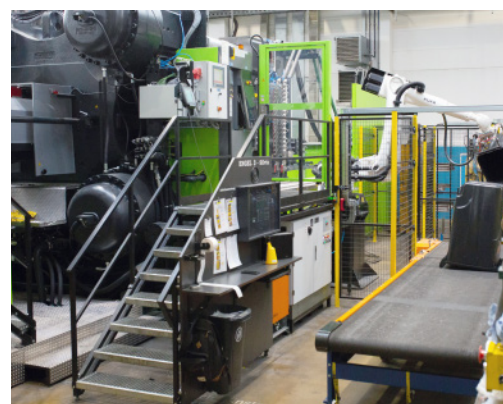
Produkcja pojemników na odpady na maszynie ENGEL duo 4000: przetwarzane są surowce wtórne pochodzące ze zbiórki odpadów pokonsumpcyjnych.
