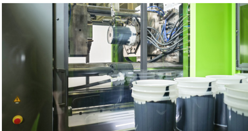
Aby zademonstrować wysoką zawartość materiałów pochodzących z recyklingu, przezroczysty materiał skóry wykonany z materiału pierwotnego jest połączony z czarnym materiałem pochodzącym z recyklingu.
