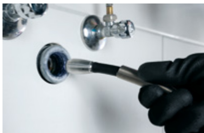
Der kompakte Ø 20 mm Kopf liefert brillante und hochauflösende Bilder
