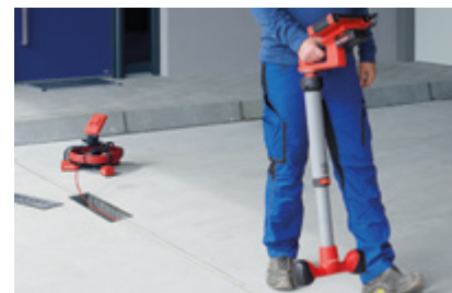
Mit Hilfe des Moduls ROLOC Plus HD kann der Ortungssender schnell und einfach gefunden werden
