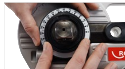
Werkzeuglose Voreinstellung des Biegewinkels
