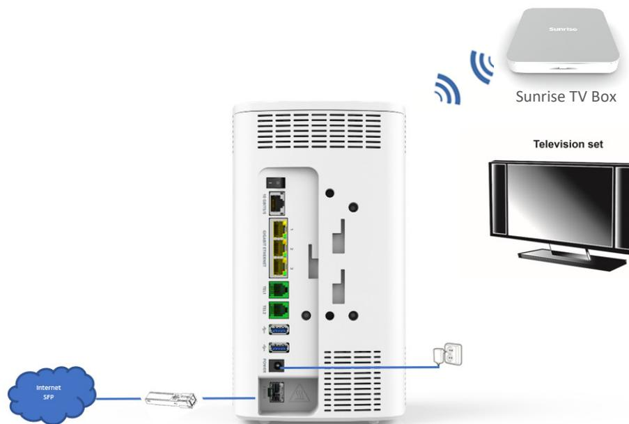
Figura 2.6 - Collegamento di un Set Top Box in modalità Wi-Fi
