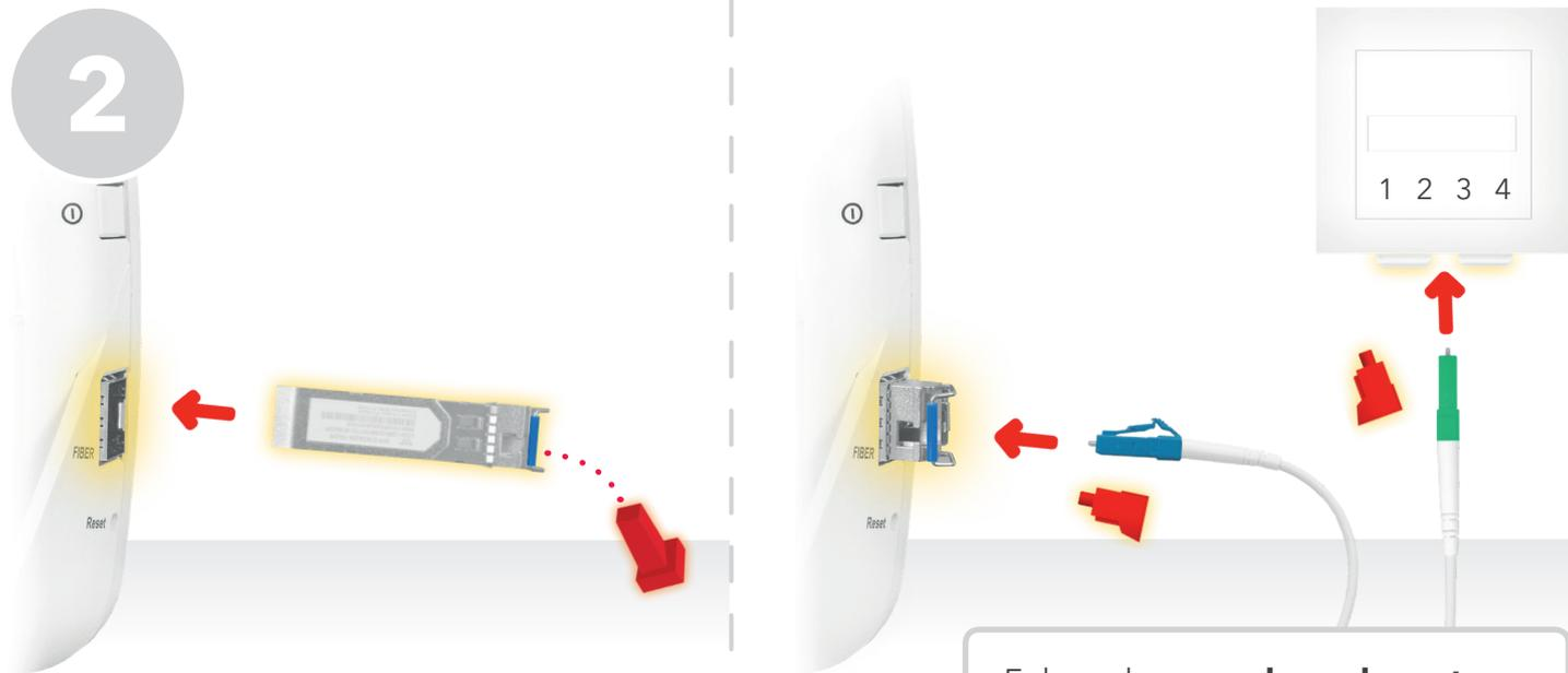
Enlevez le **capuchon de protection** du module pour la fibre optique, puis le connecter à la box.
