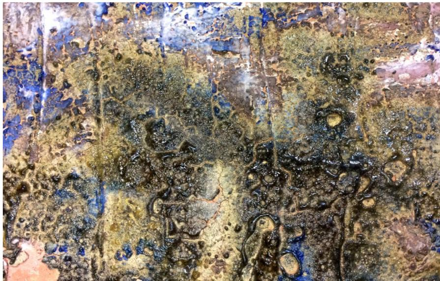
**Figura 9.** Óxidos metálicos activados, cristalizados, pero muy inestables adheridos con fragilidad a cemento refractario.
