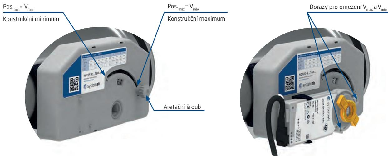
Obr. 4: Detail mechanismu pro nastavení průtoku vzduchu
