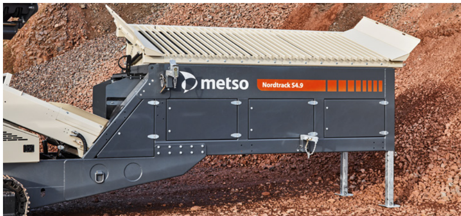
Vankka kalteva ritilä, jossa kauko-ohjattava kallistus Mahdollisuus täryvälppän käyttöön
