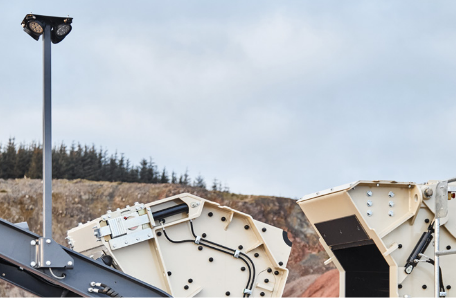
Daha iyi çalışma ergonomisi ve güvenlik için standart olarak çalışma lambaları.
