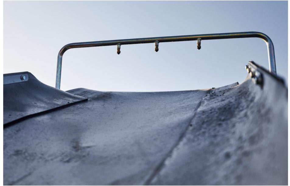
Sistema de pulverização de água para eliminação eficiente de pó, bomba incluída.
