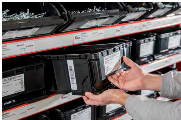
RFID-Kanban System zur automatisierten C-Teile-Versorgung
